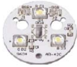
Рис. 5. Плата из фольгированного алюминия с мощными светодиодами
